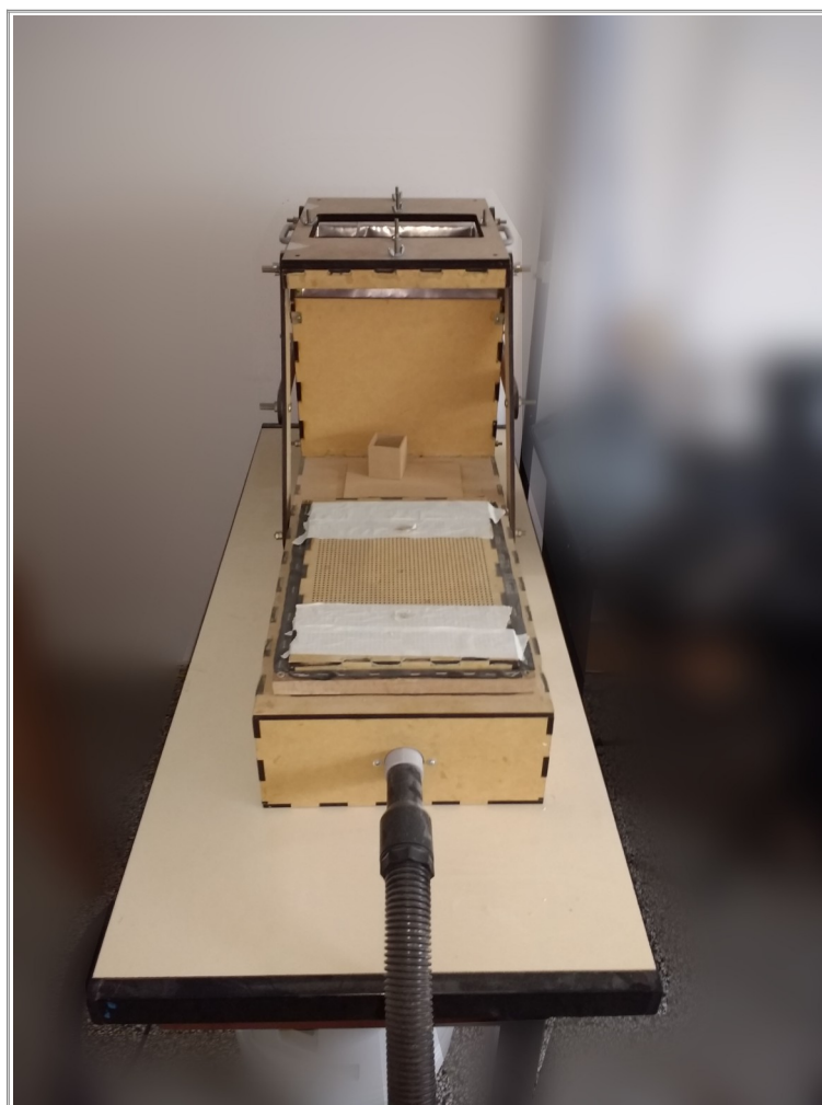
Figura 12 – vacuum forming , tecnologia formativa concebida e fabricada no próprio Pronto 3D/UFSC
