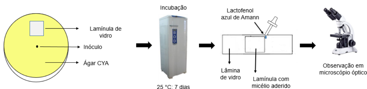
Figura 8 - Representação esquemática da técnica de microcultivo em lâmina proposta por Riddel, 1950 (com adaptações)
