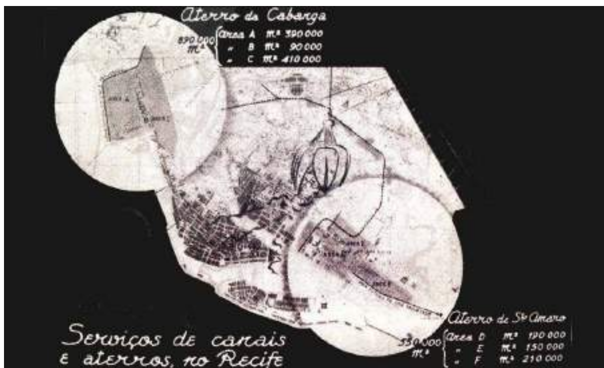
Figura 17 - Aterros realizados em Santo Amaro para construção do canal ligando o Derby à bacia de Santo Amaro.
