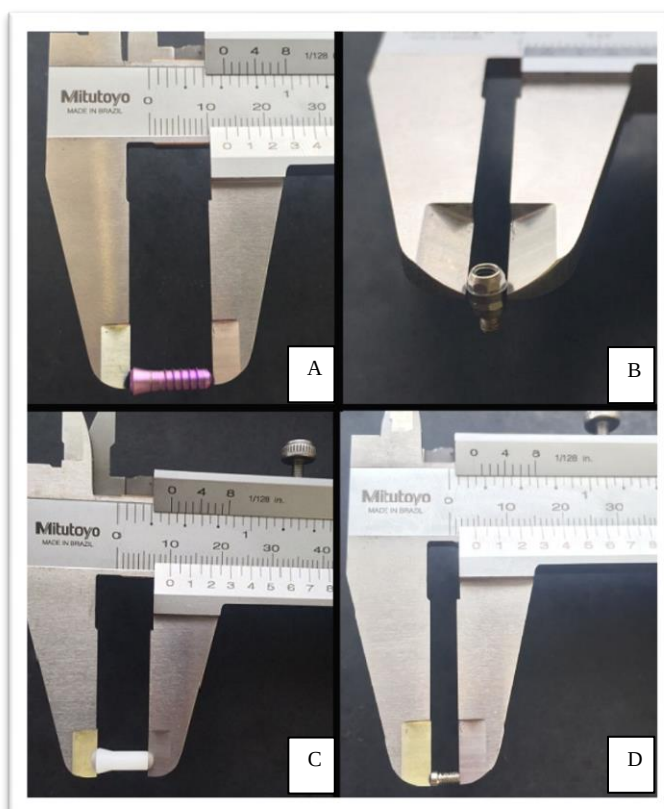
Figura 5 - Medições dos componentes: A) implante tissue level B) intermediário synocta C) coping D) parafuso protético
