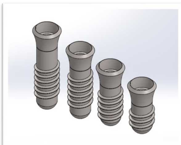
Figura 4- Implantes tissue level modelados em diferentes comprimentos de 10, 8, 6 e 4 mm
