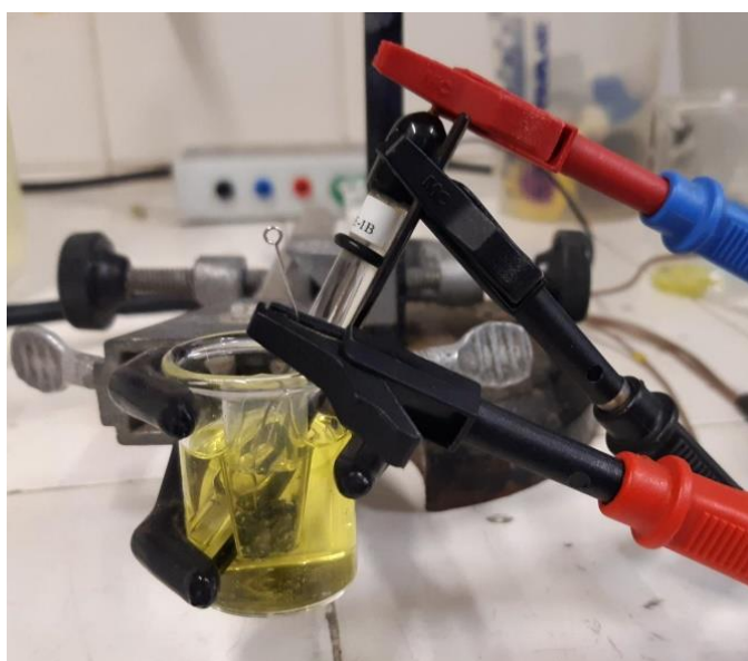
Figura 46– Estudo voltametrico do eletro compósito por voltametria cíclica no sistema de \text{K}_3[\text{Fe}(\text{CN})_6]
