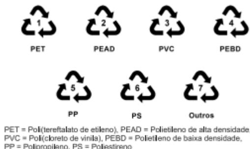
Figura 2. Simbologia utilizada para identificação de embalagens plásticas, Norma NBR 13.230 da ABNT (Associação Brasileira de Normas Técnicas)
