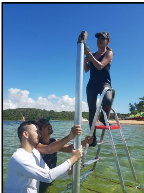
Figura 5. Procedimento de encravamento do tubo de alumínio, por meio de sondagem à percussão, no fundo da Lagoa Arituba, Nísia Floresta – RN, agosto de 2017.
