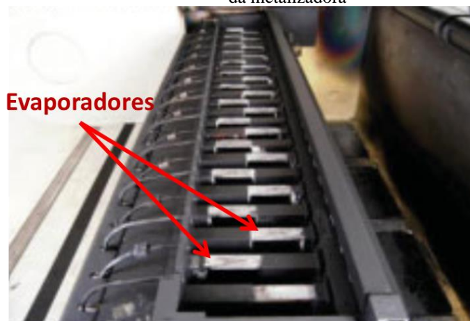
Figura 12 - Evaporadores dispostos de forma alternada dentro da metalizadora
