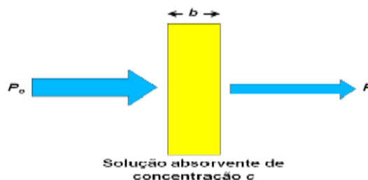
Figura 12- Atenuação do feixe de radiação por uma solução absorvente
