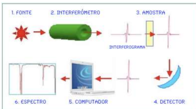
Figura 10 - Esquema do processo de análise de uma amostra no FTIR
