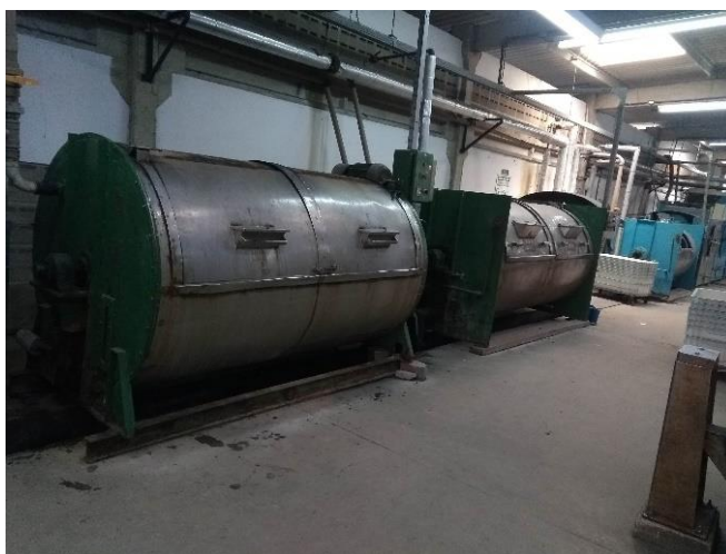
Figura 30 - Dornas utilizadas no processo de lavagem dos jeans
