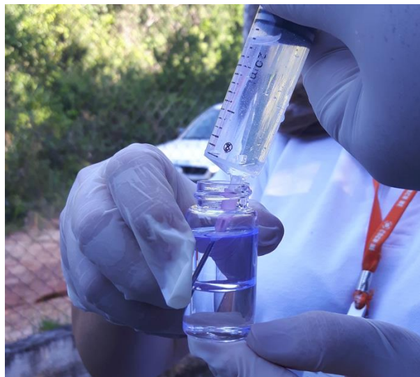
Figura 23 – Injeção de amostra de água em frasco com solução cintilador para determinação de Rn
