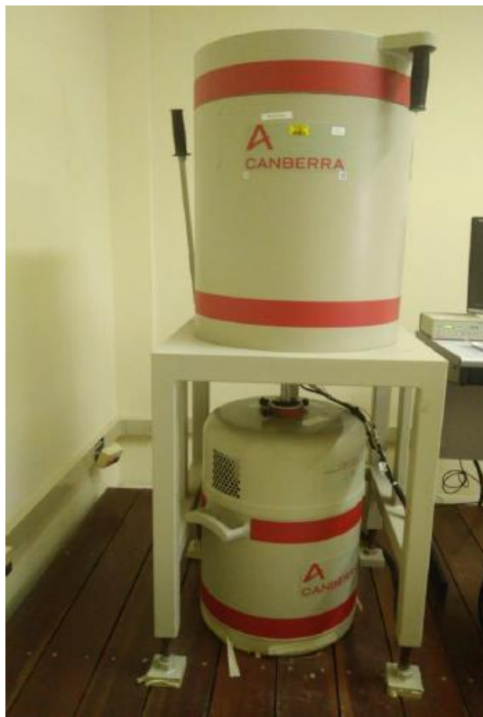
Figura 17 – Sistema de Espectrometria Gama com detector HPGe, modelo GC4018, produzido pela Canberra
