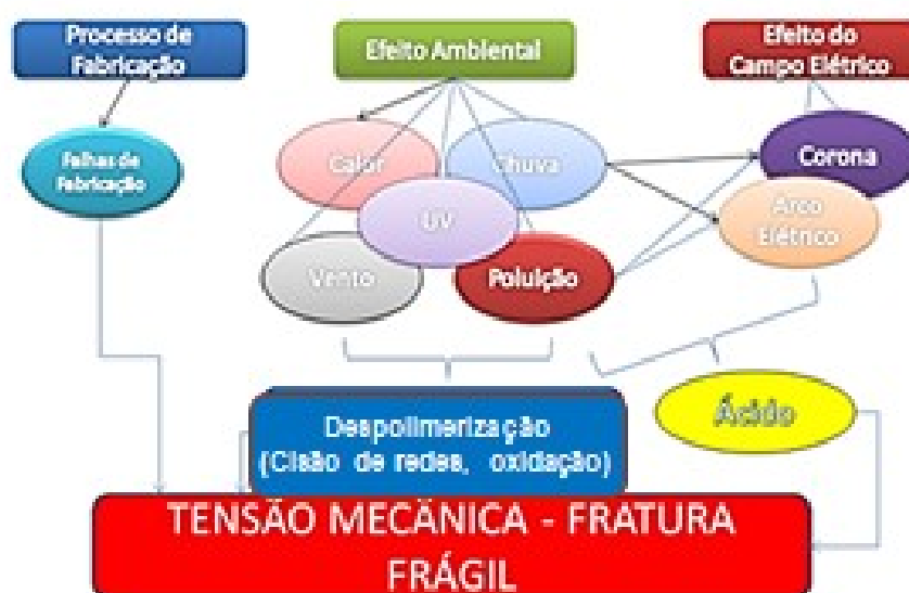
Figura 9 - Fatores que degradam as propriedades mecânicas e elétricas dos isoladores poliméricos
