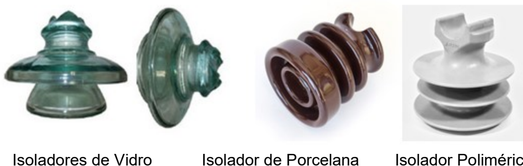
Figura 3 - Isoladores utilizados em redes de distribuição de 13,8 kV: poliméricos, isoladores de porcelana e isoladores de vidro de classe 15 kV
