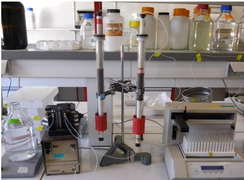
Operação dos ensaios experimentais de coluna do solo
