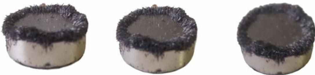
*Figura 33 - Fotografias do acúmulo de pó de aço sobre a superfície do ímã de cilindro para demonstrar que há uma maior intensidade do campo magnético devido a uma quantidade maior de linhas de campo nessa região do ímã. Fonte: Autoral*
