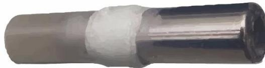
*Figura 11 - Ímã de neodímio em forma de cilindro utilizado como 2ª configuração para o gerador. Fonte: Autoral.*
