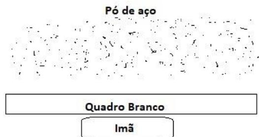
*Figura 13 - Ilustração de como deve ser feito o experimento das linhas de campo para as configurações dos ímãs. Fonte: Autoral*
