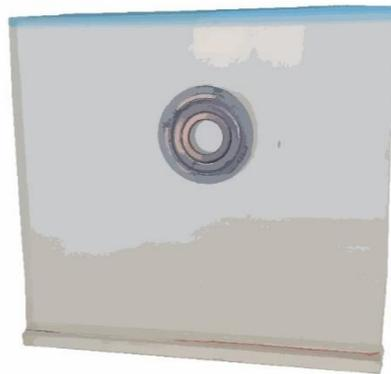
*Figura 17 - Placa de acrílico com o rolamento inserido. Fonte: Autoral*
