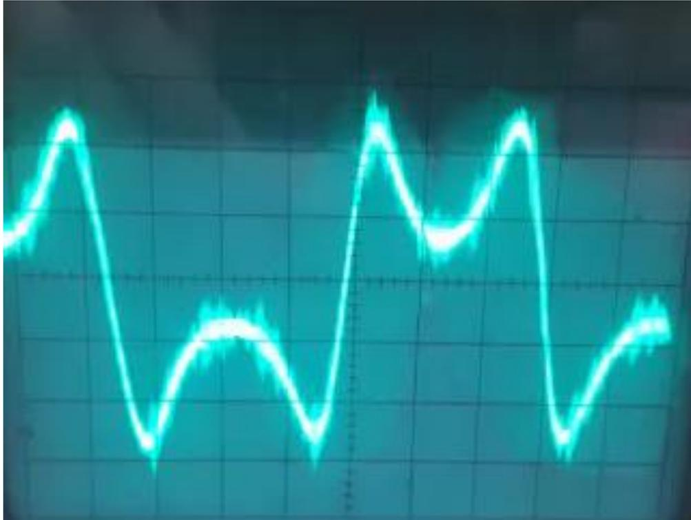
*Figura 29 - Fotografia do monitor do osciloscópio representando o gráfico de TENSÃO por TEMPO da 2ª montagem do gerador com a bobina de 600 espiras. O eixo horizontal representa o tempo com escala de 20 ms e o vertical a tensão com escala de 0,1 V. Fonte: Autoral*
