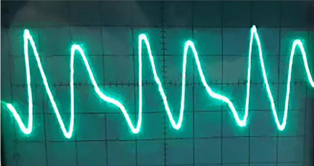
*Figura 31 - Fotografia do monitor do osciloscópio representando o gráfico de TENSÃO por TEMPO da 3ª montagem do gerador com a bobina de 600 espiras. O eixo horizontal representa o tempo com escala de 0,2 s e o vertical a tensão com escala de 1 V. Fonte: Autoral*
