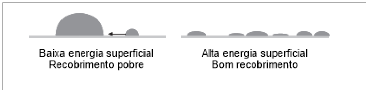
Figura 3 – Efeito da energia superficial sobre a qualidade do recobrimento. A depender das condições da superfície do filme para metalização, pode ocorrer a formação de filmes com altos valores de densidade óptica, porém com recobrimento pobre.
