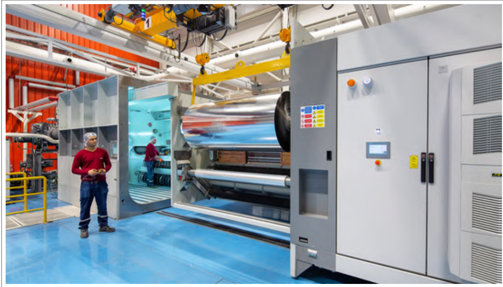
Figura 1 – Imagem do produto final do processo industrial de metalização a vácuo. O filme metalizado pode apresentar dimensões variadas, com até 4,45 m de largura e até 85 km de extensão.
