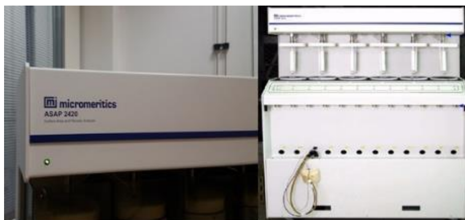
Figura 4 - Ensaio dos materiais utilizados na pesquisa, verificação da área específica.
