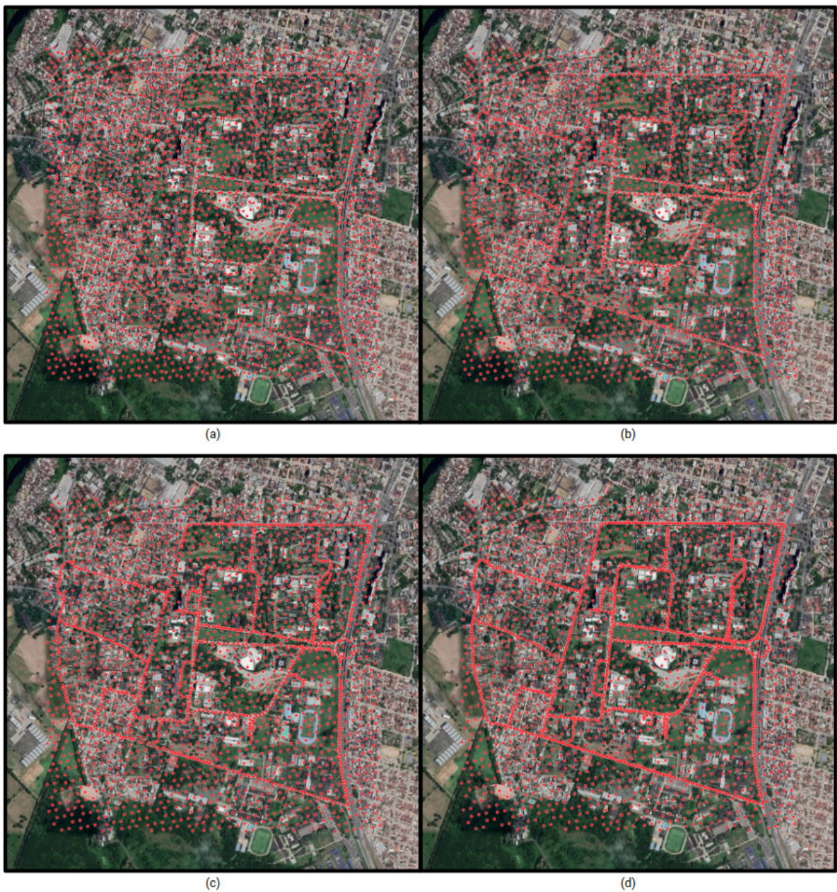
Figura 22 – Exemplo de gridmaps irregulares com c = 2500 células gerados para a região de cobertura. Em (a), (b), (c) e (d) podemos visualizar gridmaps onde uma percentual p = 10\% , p = 20\% , p = 30\% e p = 40\% das células foram designadas as regiões prioritárias.
