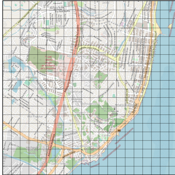
Figura 2 – Segmentação da região de cobertura proporcionado através de uma malha quadricular. O conjunto de todas as coordenadas espaciais associadas ao centro das células é conhecido como gridmap , sendo esse conjunto, utilizado para representar computacionalmente essa região.
