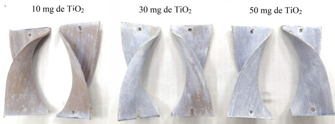
Figura 18 – Fotografia dos Misturadores estáticos recobertos com diferentes massas de TiO 2
