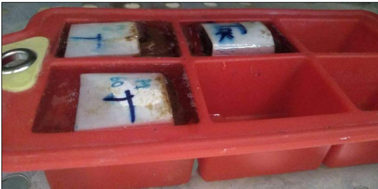
Associado a impregnação foi utilizada uma bomba de vácuo conectada a um dessecador que abriga a resina e as amostras. Com a polimerização, a amostra tornou-se resistente, mas sem perder a estrutura original, o que permitiu proceder com o seu corte, sua laminação e por último o polimento. O endurecimento completo das amostras ocorreu após quatro semanas.
