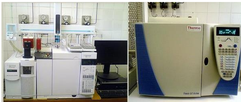
Figura 23: Cromatografo gasoso acoplado à espectrometria de massas (CG/EM) e cromatografo gasoso com detector de ionização em chamas (GC-DIC) utilizados na identificação e quantificação dos óleos essenciais respectivamente
