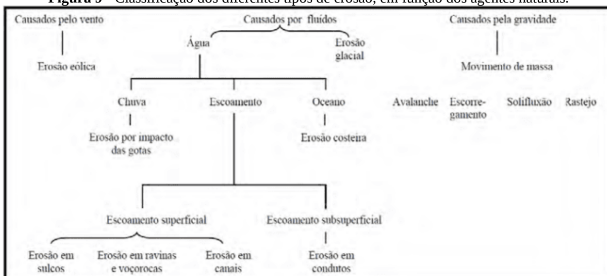
Figura 9 - Classificação dos diferentes tipos de erosão, em função dos agentes naturais.
