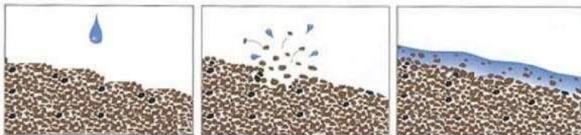
Figura 10 - A atuação da gota da chuva sobre superfície do solo exposto ocasionando o splash ocorrendo a desagregação das partículas do solo.
