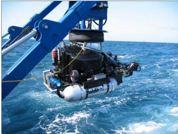
Fotografia 02 – ROV para fazer prospecção subaquática.
