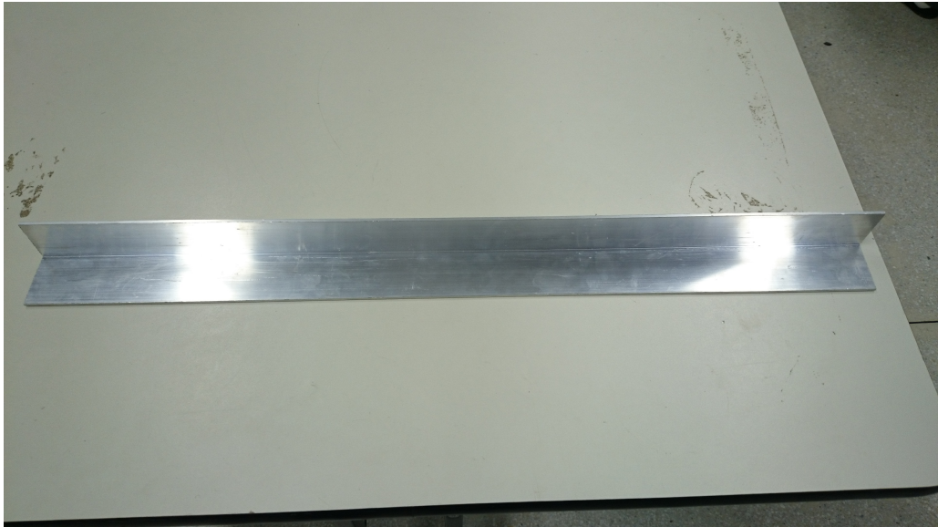
Figura 12: Cantoneira usada para montagem dos suportes.
