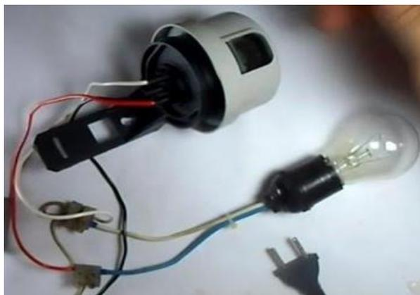
Figura 40: Relé fotoelétrico 220V, lâmpada incandescente no bocal e plug.
