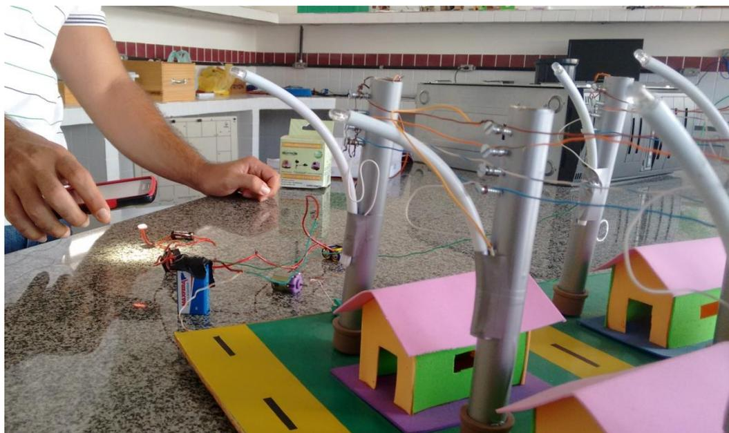
Figura 33: Circuito de baixa tensão em funcionamento, LDR iluminado.
