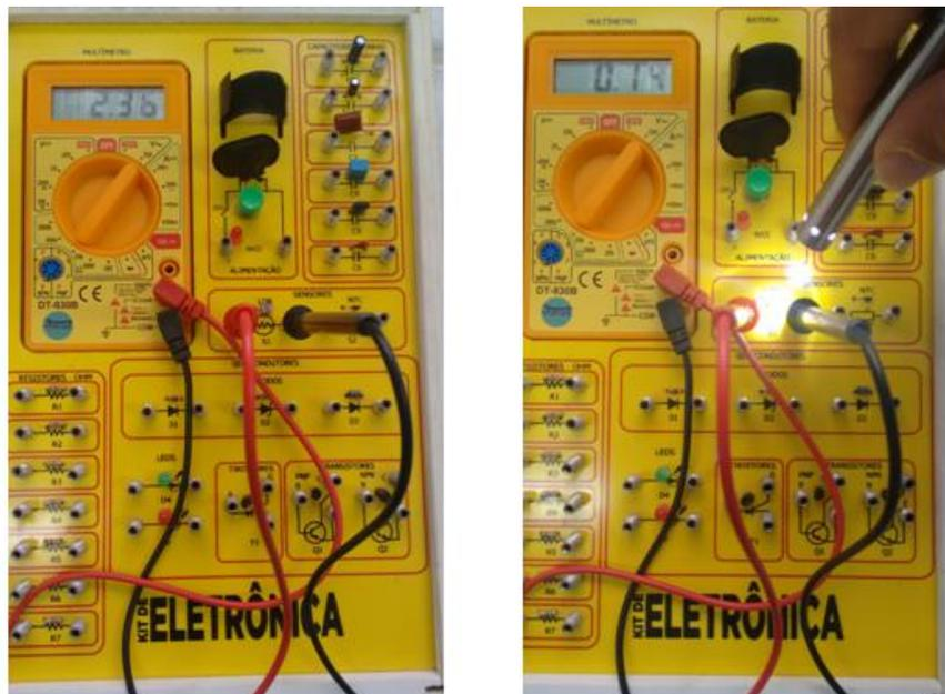
Figura 35: Montagem multímetro – LDR, utilizando-se Kit de eletrônica, sem iluminação (esquerda) e iluminado (direita).
