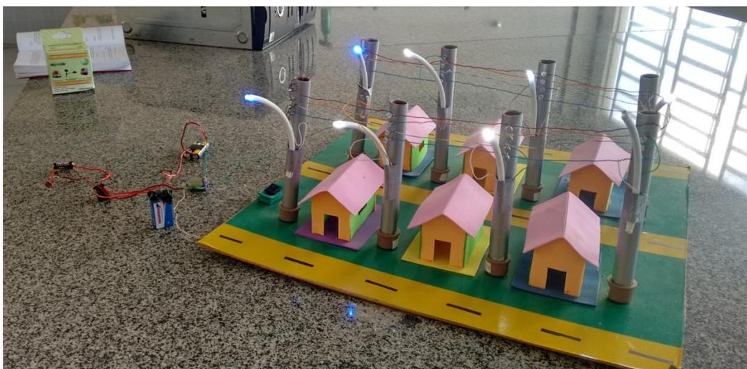
Figura 32: Circuito de baixa tensão em funcionamento, LDR não iluminado.
