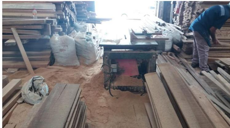
**Figura 4:** Serra parcialmente obstruída por produtos. **Fonte:** Do autor
