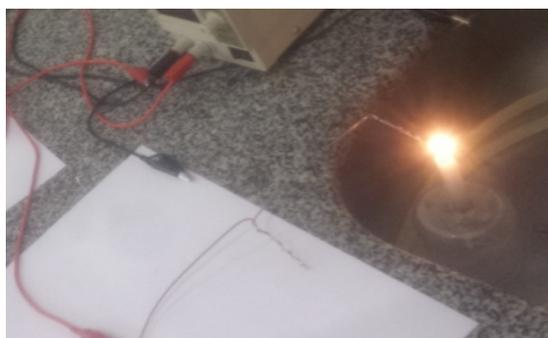
**Figura 47. Junção do termopar submetida à chama de uma vela.**
