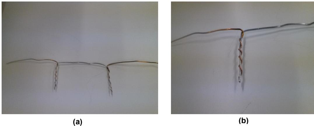
**Figura 43. Termopares de Cobre e Alumínio. (b) Junção de Alumínio e Cobre**
