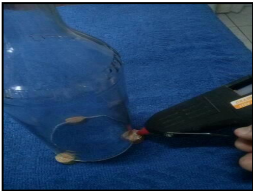
Figura 1.5: Colagem da base (1º Passo).
