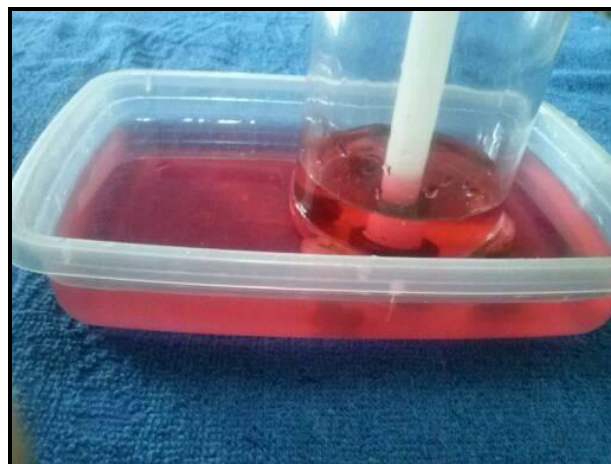
Figura 2.1.3: Observação da diferença de altura entre a parte interna e externa da garrafa (coluna visível do líquido no interior da garrafa ).
