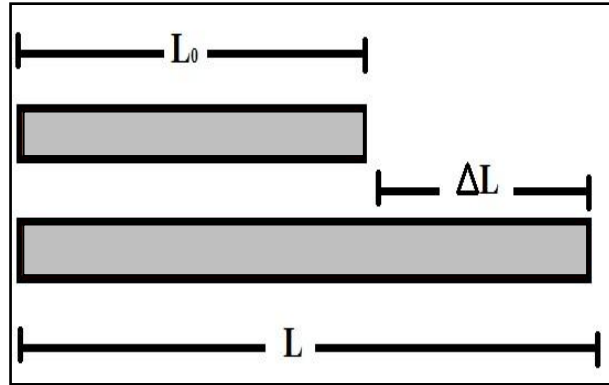
Figura 2.2: Quando uma barra de aço é aquecida, todas as suas dimensões lineares são ampliadas na mesma proporção.
