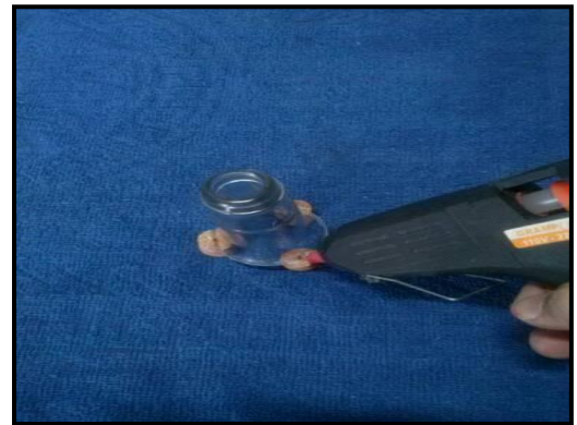
Figura 1.6: colagem da base (2º Passo).
