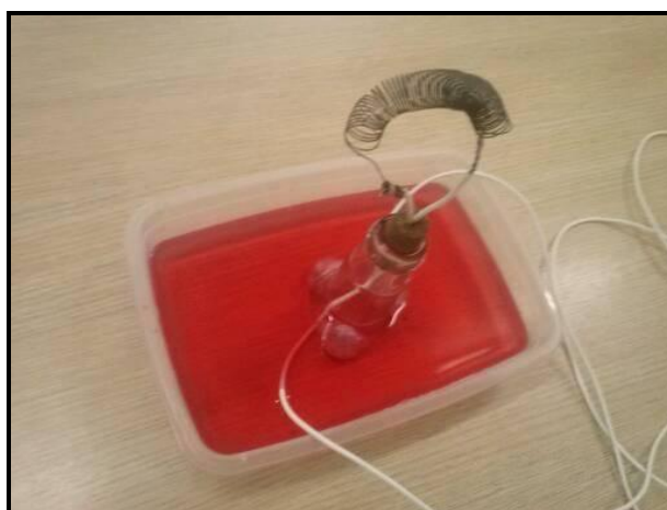
Figura 2.1.4: Resistência elétrica ligada.
