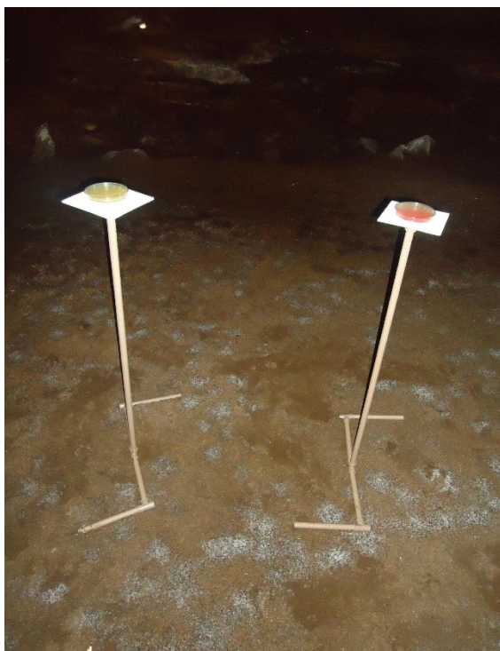
Figura 5: Hastes de sustentação feitas de PVC confeccionadas para a coleta dos fungos do ar na caverna “Meu Rei”.
