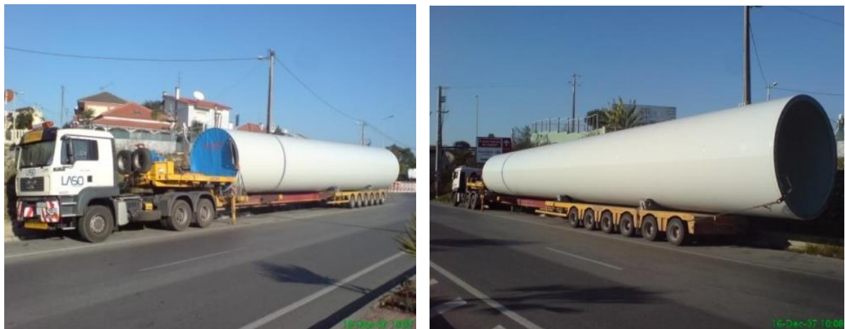
Figura 11 - Transporte de um segmento tubular de uma torre eólica.
