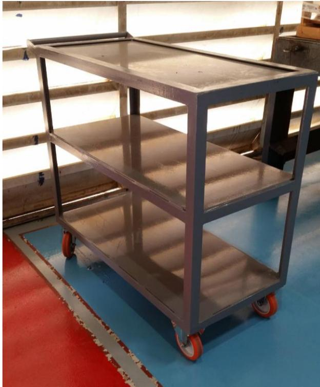
*Figura 27 – Carrinho para armazenagem e transporte de materiais em processo.*
