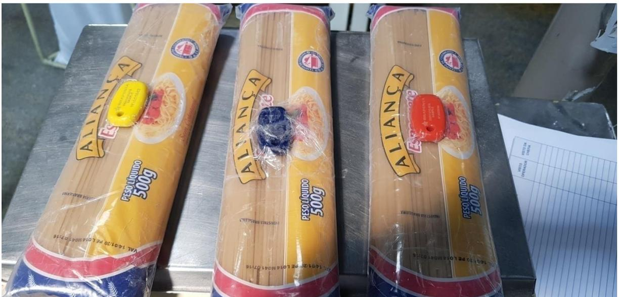
*Figura 4.11 – Amostras de Verificação do Detector de Metais.*
