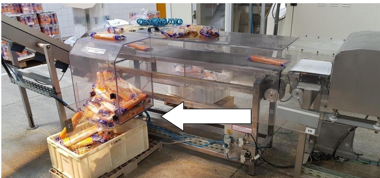
Figura 4.12 – Falha de Descalibração da Balança.
