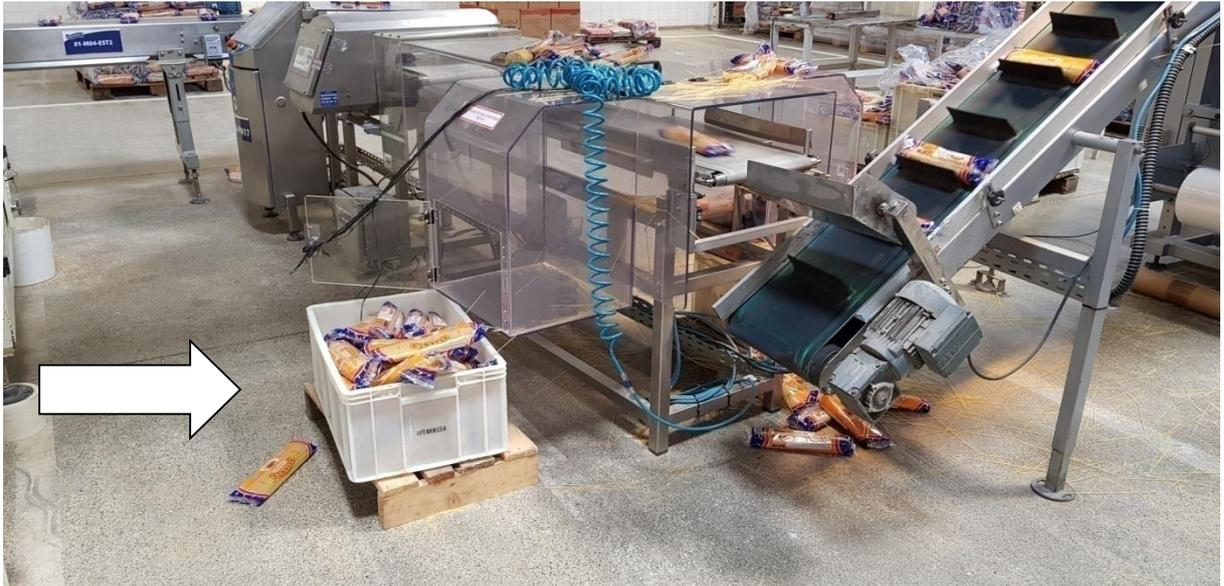
*Figura 4.10 – Falha de Descalibração do Detector de Metais.*
