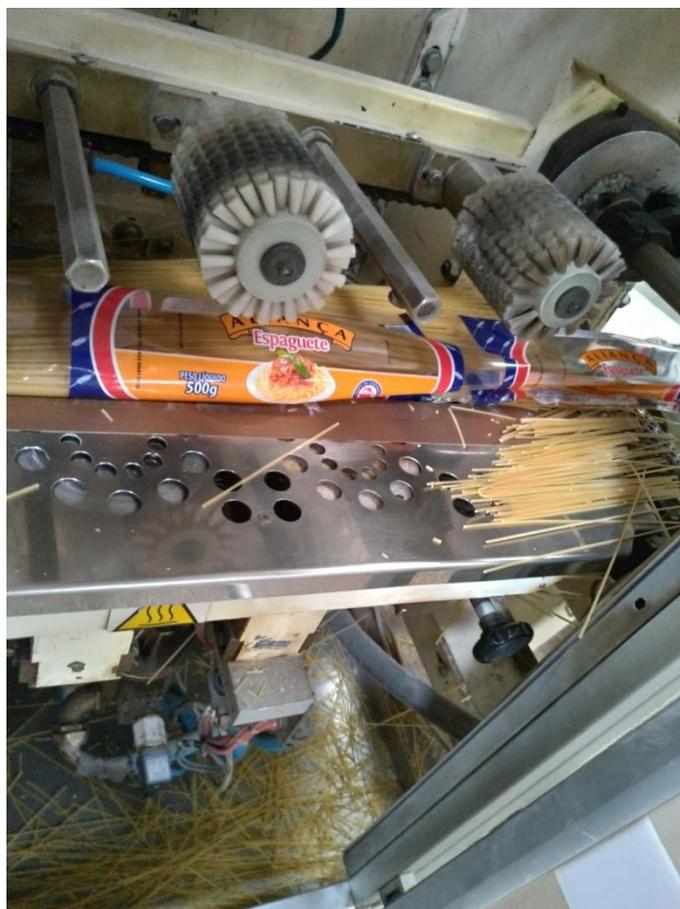
*Figura 4.9 – Falha de Selagem.*
