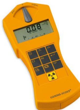
Figura 2: Contador Geiger-Muller para radiação alfa, beta e gama.
