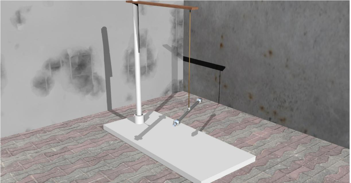
Figura 11: Pêndulo de torção.
