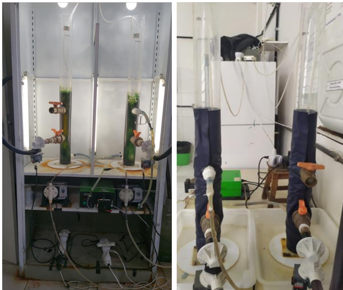
Figura 8 - Imagem dos reatores e fotobiorreatores. À esquerda: FRBS1 e FRBS2, à direita: RBS2 e RBS1
