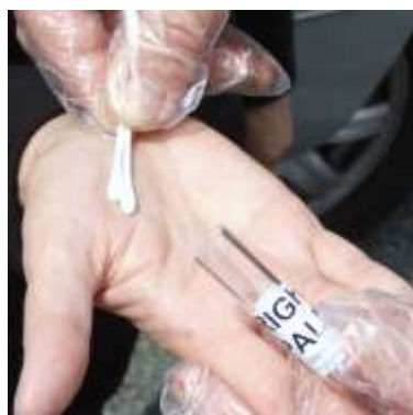
Figura 4- Coleta de GSR utilizando suabes na forma de hastes flexíveis 3 .
