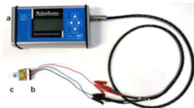
Figura 14- Analisador portátil PalmSens (a), conector (b) e eletrodo impresso (c).
