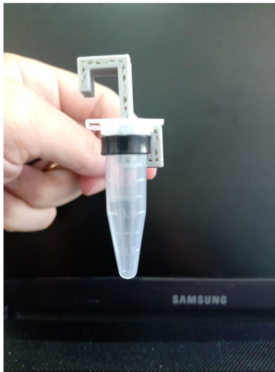
Figura 8- Alças em PLA produzidas em impressora 3D para fixação dos frascos de amostras coletadas.
