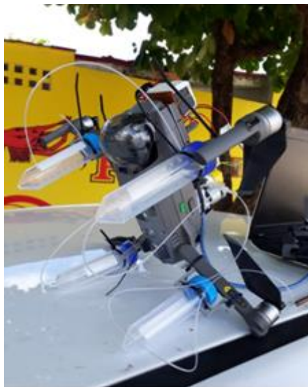
Figura 12- Acoplamento do sistema automático de amostragem ao UAV de modelo MAVIC PRO da empresa DJI
