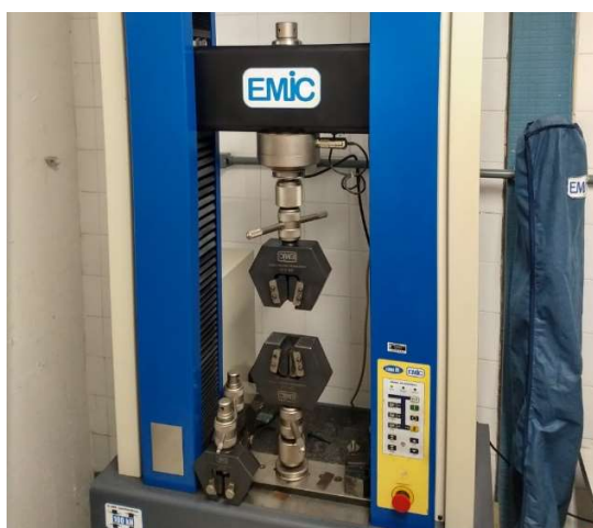
Figura 13 - Equipamento utilizado para realização do ensaio resistência ao cisalhamento
