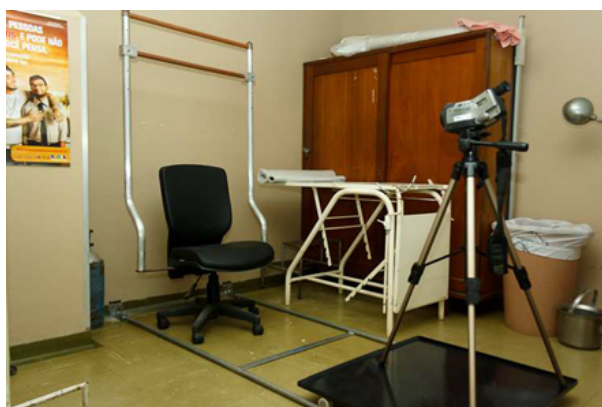
Figura 7 – Aparato para aquisição de imagens termográficas de mama.
