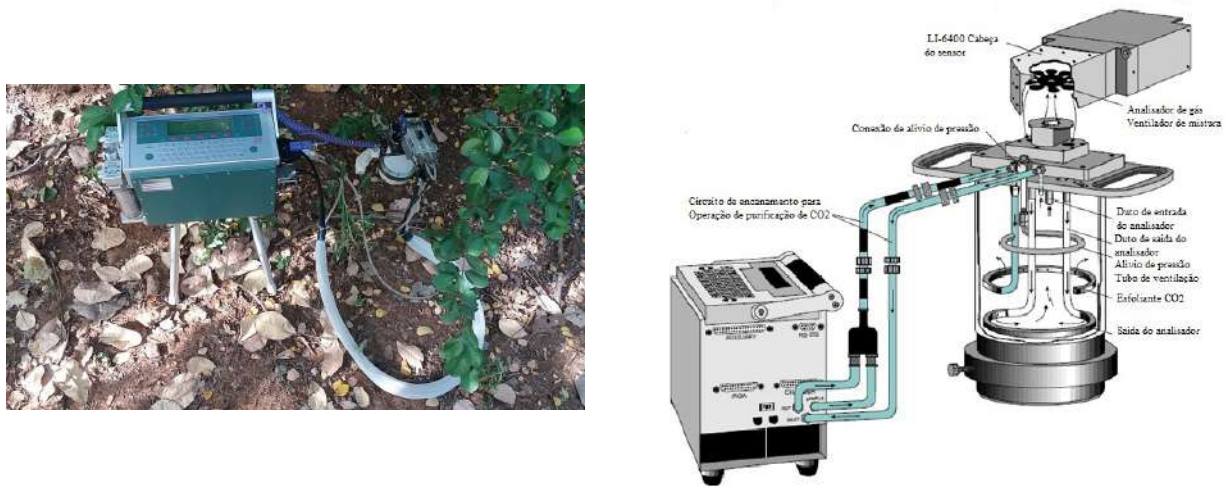
Figura 6 – Analisador de gás por infravermelho (IRGA) modelo LI6400-XT-LI-COR, equipado com uma câmara de retenção de CO 2 (LI-6400-09, LI-COR, Lincoln, NE, EUA)
