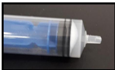
Figura 36 – Seringa com solução de 10% PVA com 0.1% de HP
