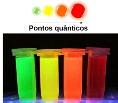
Figura 1 – Pontos quânticos com a mesma composição química emitindo fluorescência em diferentes comprimentos de onda, sintonizável com o tamanho.
