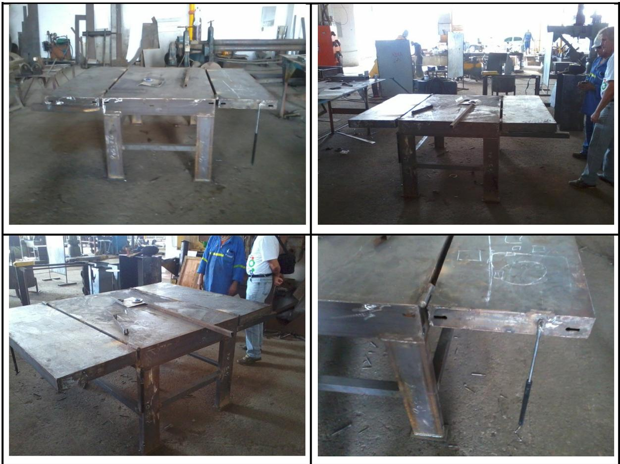
Na segunda visita a mesa já estava totalmente montada e praticamente pronta, restando apenas sua pintura. Foi uma visita em que foi testada a força necessária para abertura e fechamento das extensões laterais. Após os testes, conclui-se que esta força estava em conformidade com os requisitos do projeto. Então, foi autorizada a pintura e após alguns dias,
