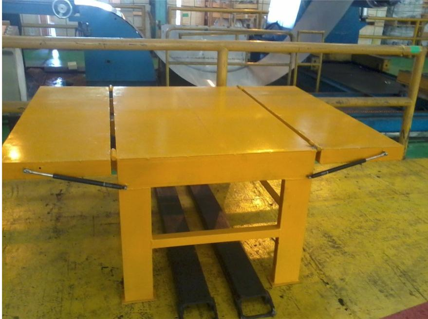
**Figura 20 - Mesa ergonômica "fechada" para chapas com um metro de comprimento.**
