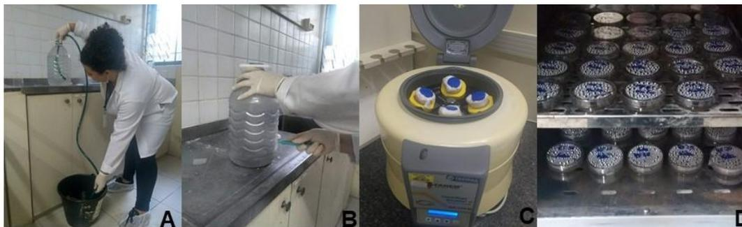
A – Sifonação; B – Abertura do galão; C – Centrifugação; D- Secagem em estufa
