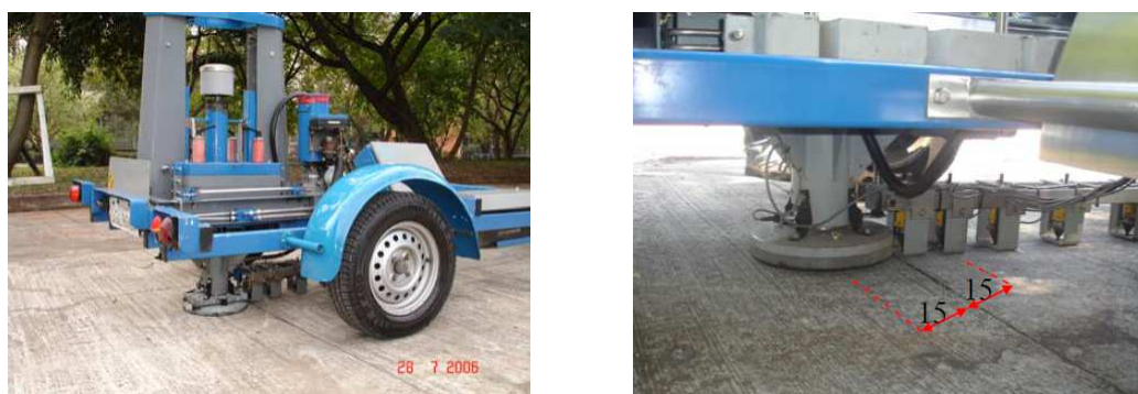
FIGURA 7 – Determinação da eficiência de transferência de carga através de FWD
