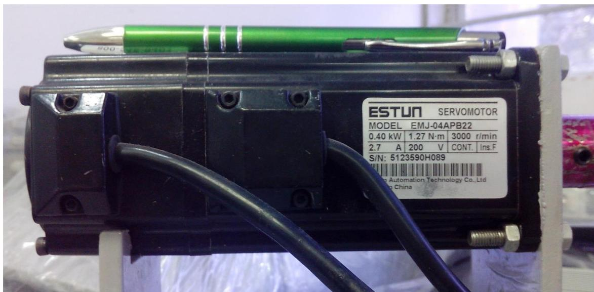
**Figura 9 - Dados de placa da máquina síncrona do kit.**
