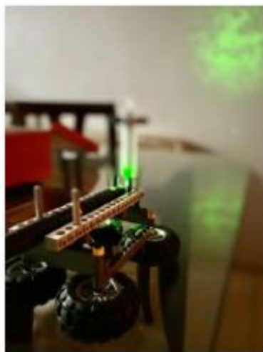
Imagem 8 - Método aplicado para visualização de microrganismos. Em primeiro plano tem o suporte da seringa com o apontador LASER e no segundo plano a projeção das sombras.
