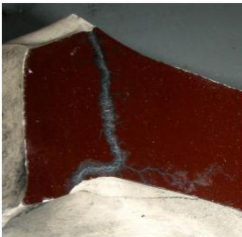
Figura 3.2 - Detalhe do pedaço de porcelana de parte da bucha com marcas de arvorejamento características de descargas parciais Fonte: Bechara (2010, p 56)
