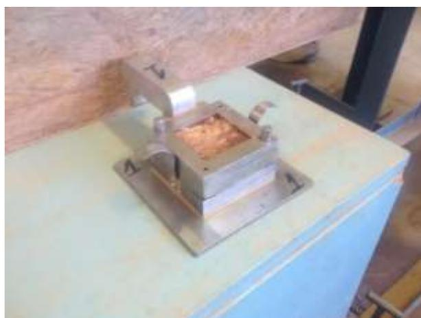
Foram ensaiadas séries de 3 corpos de prova nas tensões verticais de 50 kPa, 100 kPa e 200 kPa, com duas umidades iniciais – natural e saturada (por representar a pior situação para deflagração dos escorregamentos nas encostas, caracterizando invernos rigorosos). Inicialmente, os corpos de prova foram confinados na prensa de cisalhamento, na tensão de 100 kPa, e determinaram-se a velocidade constante de ensaio para as amostras de 0,483 mm/min. Logo
