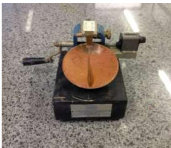
Em seguida a concha foi submetida a um total de 54 golpes, realizados com a manivela em uma velocidade de 2 voltas por segundo, resultando na união das bordas inferiores da ranhura em 1 cm de comprimento. Logo após, transferiu-se imediatamente para uma cápsula identificada pelo nº 18 uma pequena quantidade do material da região de contato das bordas que se uniram. Em seguida a amostra foi pesada e levada à estufa, para a determinação de sua umidade.
