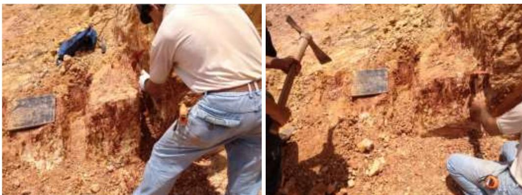
Figura 4.5 - Coleta de amostras indeformadas (tipo bloco).
