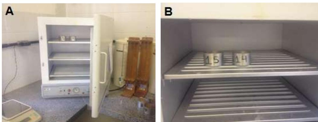
Com a obtenção dos dados a partir do ensaio realizado, foram executados os cálculos para a obtenção da quantidade percentual de água existente na amostra, através da equação 40, que relaciona o peso de água presente na amostra de solo pelo peso seco das partículas sólidas do solo.
