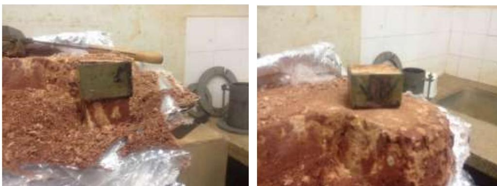
Figura 4.23 - Corpo de prova na caixa de cisalhamento preparado para ensaio.
