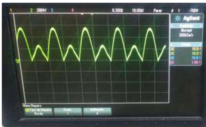
Figura 11 – Formato do sinal de 2KHz obtido com Osciloscópio
