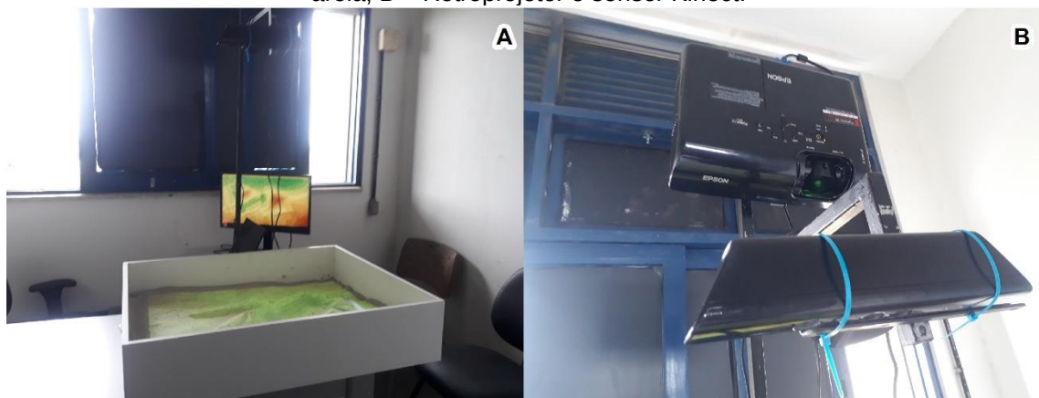
Figura 9. Materiais que compõem a SARndbox. A – Computador e caixa de madeira contendo a areia; B – Retroprojektor e sensor Kinect.
